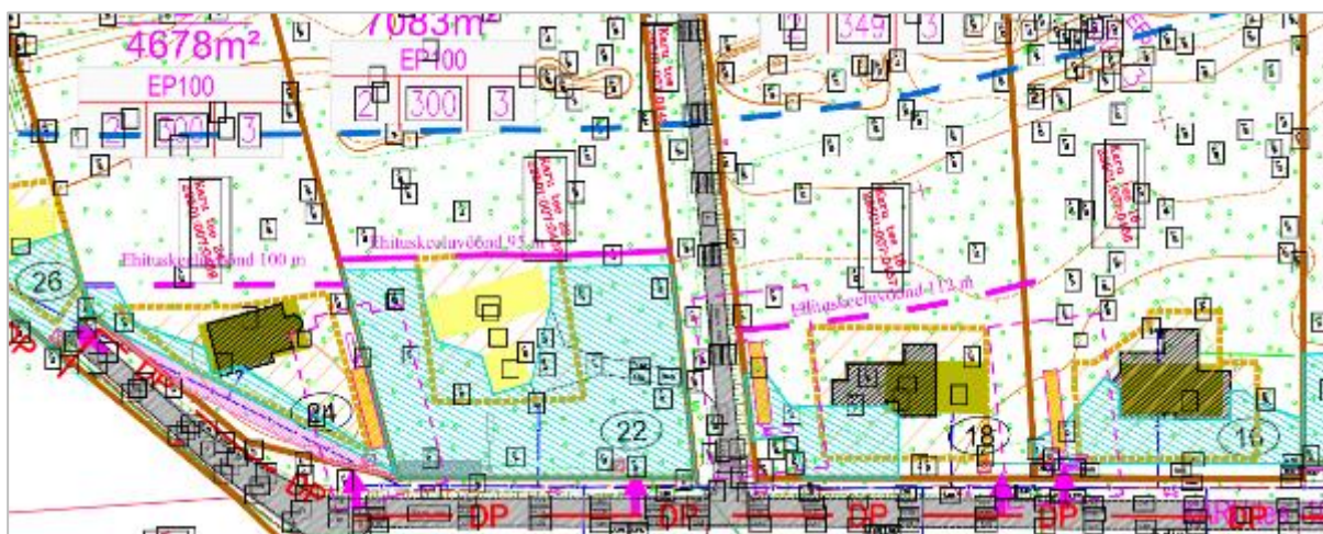
Joonis 5. Ehituskeeluvööndi vähendamise ettepanek Karu tee 18, 22 ja 24 kinnistutel metsamaal (roosa katkendjoonega). Sinise katkendjoonega on tähistatud ÜP järgne 70 m ehituskeeluvöönd. Allikas: käsitleva DP põhijoonis (01.03.2018 versioon)
