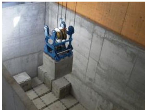
Radioaktiivsete jäätmete pakendid vaheladustuspaigas.
