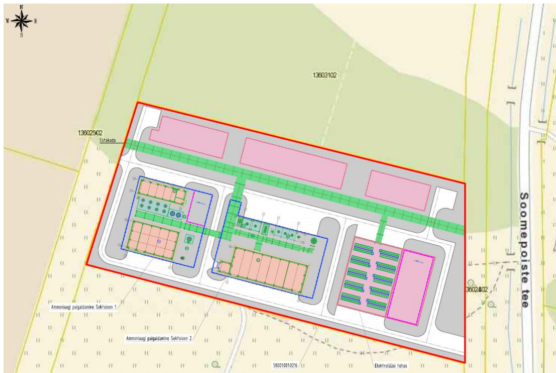
Joonis 2.1 Ammoniaagitehase tootmisüksuste paiknemise esialgne lahendus Kasesaare tee 10 (väljavõtte eskiisprojektist). Ammoniaagitehase seadmed paiknevad oranžiga tähistatud piirkonnas, muud tootmisüksused ja hooned on lillaka tooniga. Rohelisega on märgitud erinevate torustike estakaadid.
